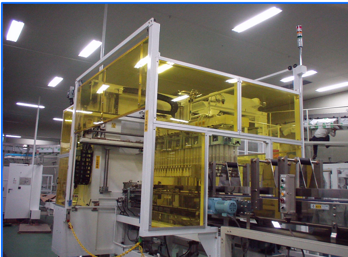
□びんハンドリング部 ※ヘッド交換により広口キャップも対応可能！
